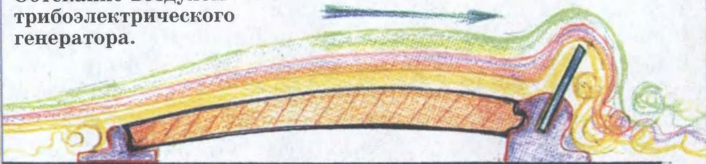
Генератор И. Клюева с ребрами для разрушения пограничного слоя воздуха (выделен красным цветом).
