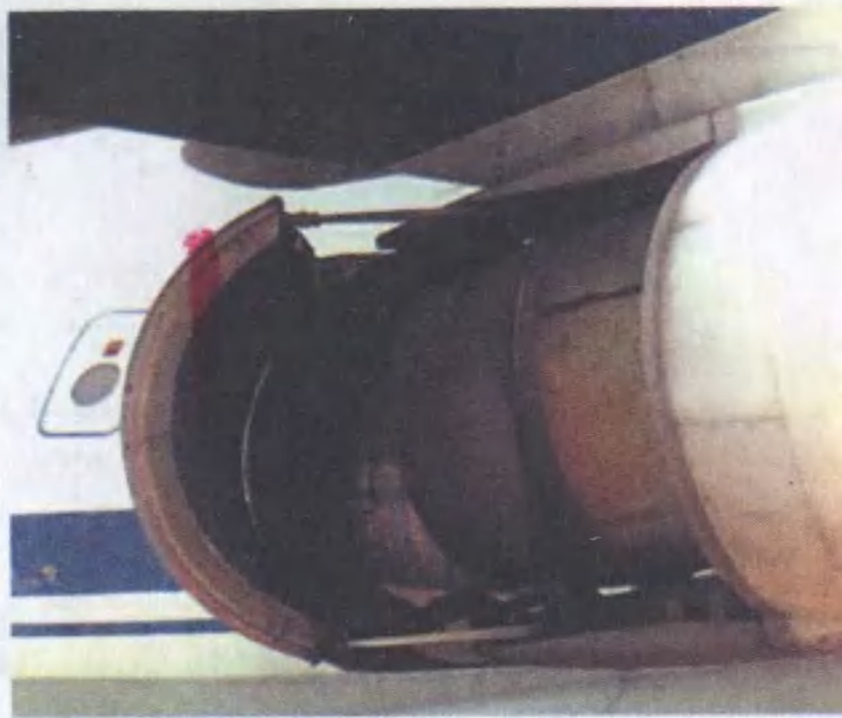
Реверс тяги двигателя самолета.
